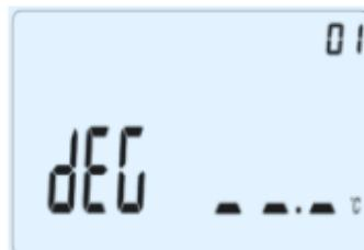
Agora, pode seleccionar um parâmetro para ajuste com as teclas de navegação, (◀) ou (▶), comutar o valor com a tecla (OK), modificar-lo com (-) ou (+) e confirmar o seu ajuste com (OK).
