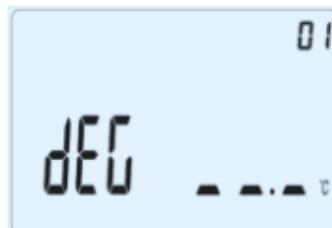
Met (◀) of (▶) gaat u naar de in te stellen parameter. Door (OK) te drukken kunt u met (-) of (+) de parameter aanpassen. Met (OK) bevestigt u de aanpassing.
