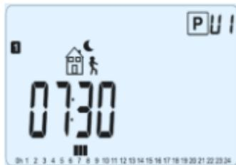
Cuando la hora del paso está ajustada, pulse **(OK)** para ir al siguiente paso.
