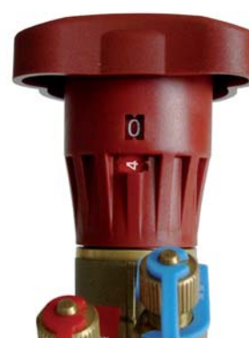
Fig. 3 Volledig geopende klep bij 4,0 omwentelingen
